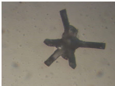
Рис. 2. Відбитки мікротвердості одержані на кристалах кремнію без покриття (а) та з мідним покриттям (б-) після травлення на дислокації.
